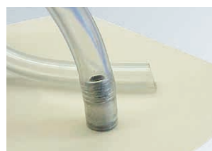
Grovit usado como conector rápido para manguera de baja presión
