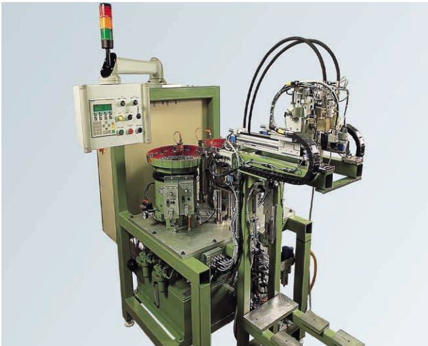
29 módulos de remachado para el montaje de bastidores de ordenadores
