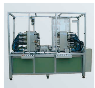
23 módulos de remachado para el montaje de bastidores para ordenadores
